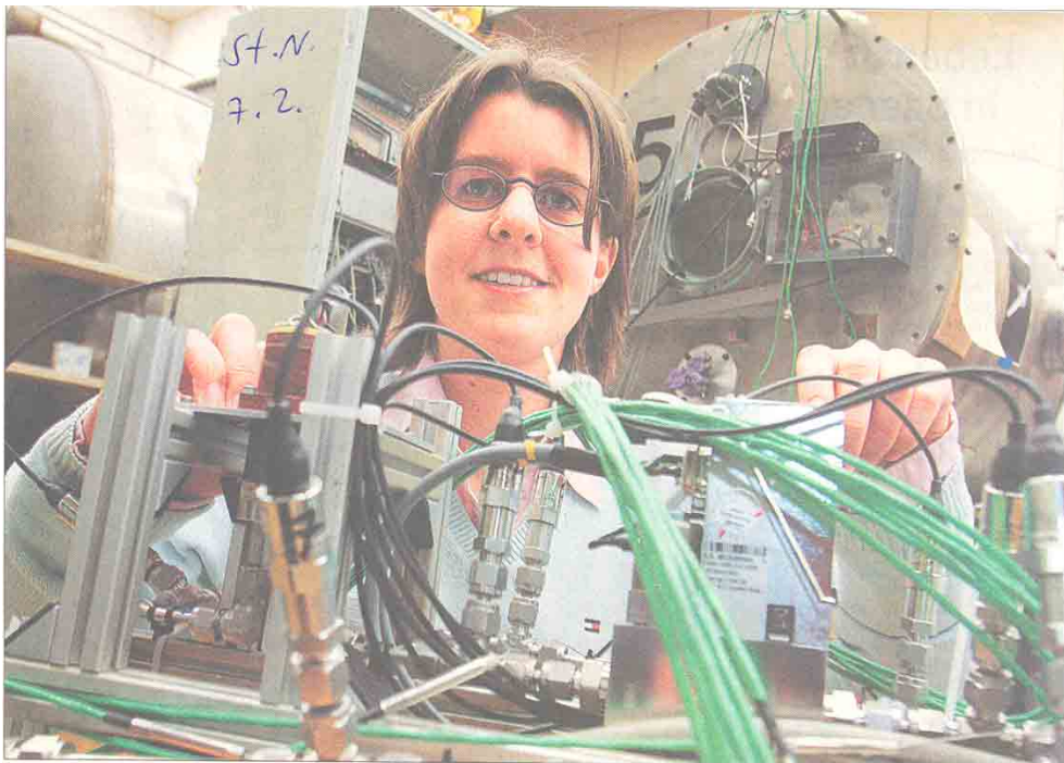
Ordrende Hand im Kabelsalat: Dagmar Bock überprüft die Treibstoffversorgung für das Triebwerk
