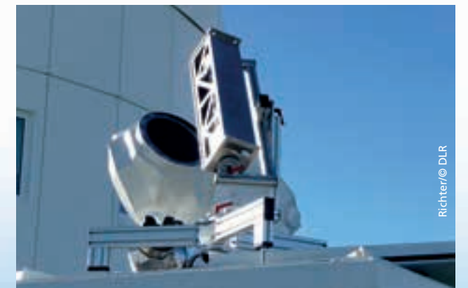
Immer zum Ziel ausgerichtet: Der optische Kopf für den Empfangspfad (weißer Kopf im Vordergrund) der T-AOGS muss hochgenau mit dem optischen Kopf für den Sendepfad (grau im Hintergrund) justiert werden. Die Justiereinrichtung ist im Vordergrund zu sehen.
