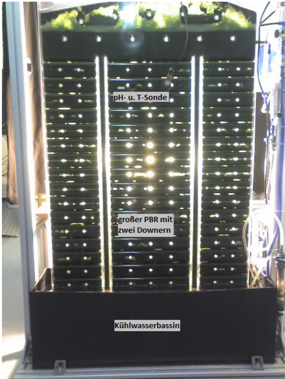
Abbildung 5: großer Chlorella -PBR dieser Aufbau kommt ohne PC aus, d.h. das Medium wird manuell zugegeben und die Daten der pH- und T(emperatur)-Sonde werden nicht gespeichert; in den Downern strömt das Medium von oben nach unten zurück
