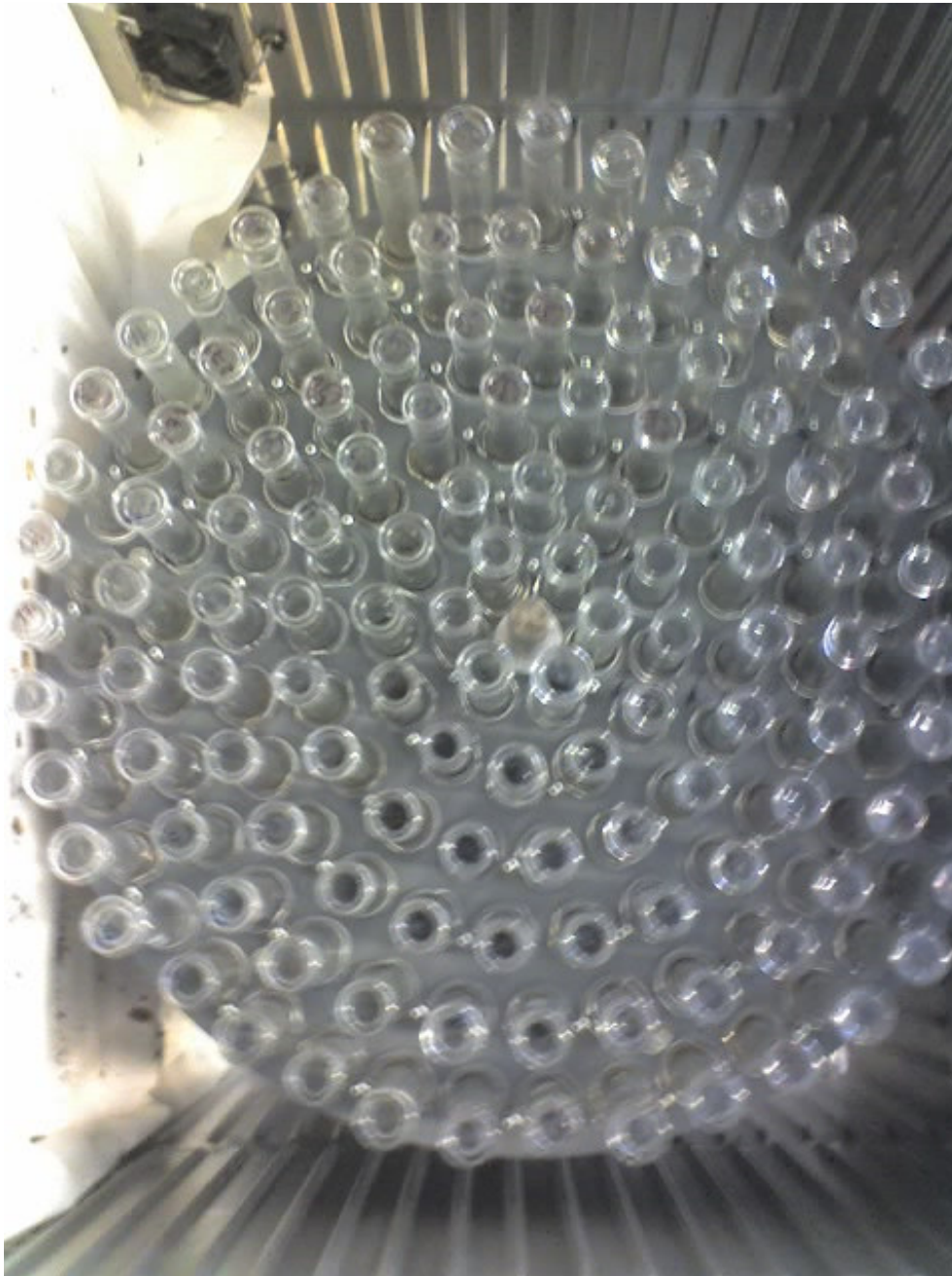
Abbildung 15: Glaskolben auf Rotator im temperierten Biogaslabor der Universität Hohenheim
