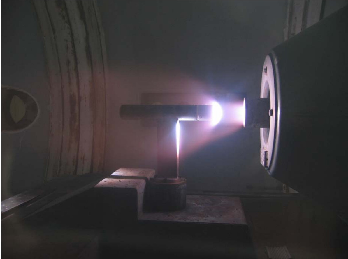
Figur 5 Plasmawindkanal mit thermischem Lichtbogengenerator im Betrieb
