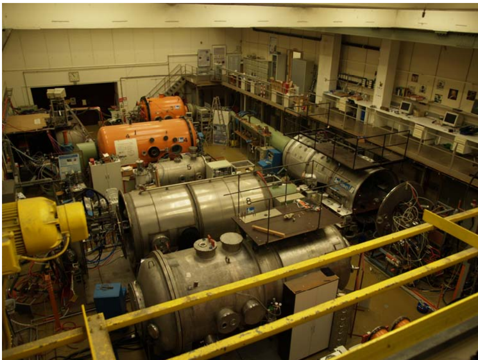
Figur 4 Große Laborhalle des IRS mit verschiedenen Plasmawindkanälen und Testständen für elektrische Raumfahrtantriebe
