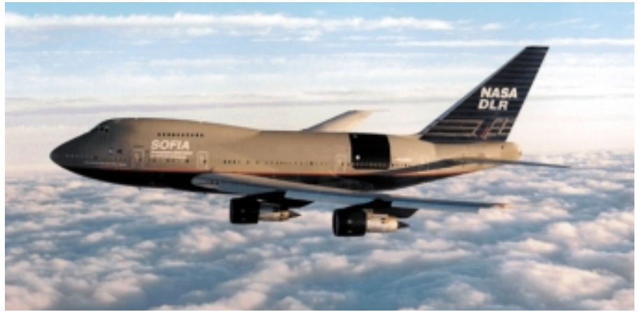
Abb. 7: Das SOFIA-Flugzeug vor der Modifikation bei der Firma Raytheon, Waco, Texas, im Frühjahr 1997. Der Platz für das Teleskop ist auf dem Rumpf schwarz markiert.
