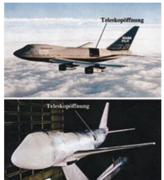
Bild 3: Oben: SOFIA-Flugzeug (Boeing 747-SP) in Beobachtungshöhe. Die schwarz gestrichene Sektion am hinteren Teil markiert die Größe der notwendigen Öffnung im Flugzeugrumpf. Unten: Ein maßstabgetreues Modell der „geöffneten“ Boeing 747-SP im Windkanal.
