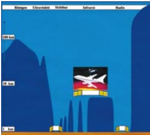
Bild 2: Dargestellt ist das Transmissionsverhalten der Erdatmosphäre in den verschiedenen Spektralbereichen. Das hellblau unterlegte Gebiet der nahezu ungehinderten Transmission reicht bei verschiedenen Wellenlängen verschieden nah an den Erdboden heran. „Beobachtungs-Fenster“ liegen im sichtbaren Spektralbereich und im Radiobereich. Im IR gelangt nur Strahlung aus einigen wenigen eng begrenzten Spektralbereichen bis zur Erdoberfläche. In Stratosphärenhöhe dagegen kann das „IR-Fenster“ weit geöffnet werden.
