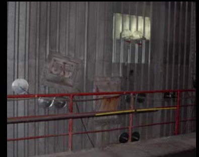
Verteilung von Messstellen im Raster 1,50m zur flächigen Messung mit mehreren Sonden
