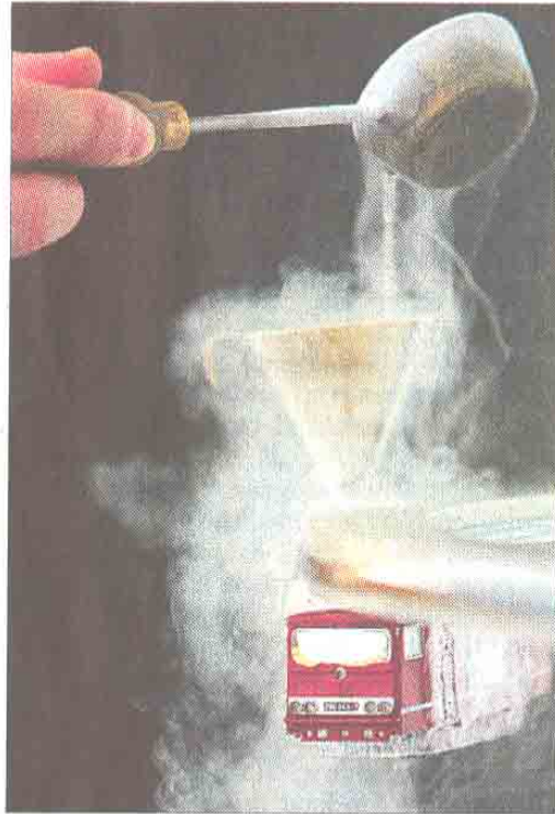
Flüssiger Stickstoff bringt eine Spielzeug-Lok mit eingebautem Supraleiter zum Schweben. Foto: ddp
